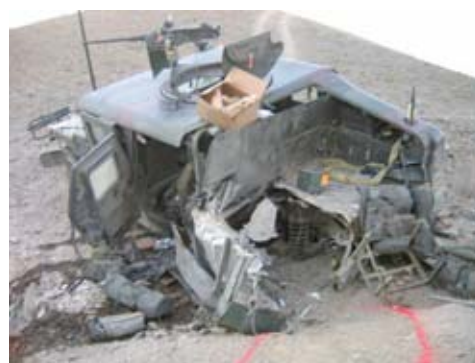
Rys. 1. Zniszczony czołg (po lewej), samochód osobowo-terenowy po wybuchu ładunku IED (po prawej) [3] Fig. 1. Destroyed tank (on left), all-terrain vehicle after explosion of blowing charge IED (on right) [3]
